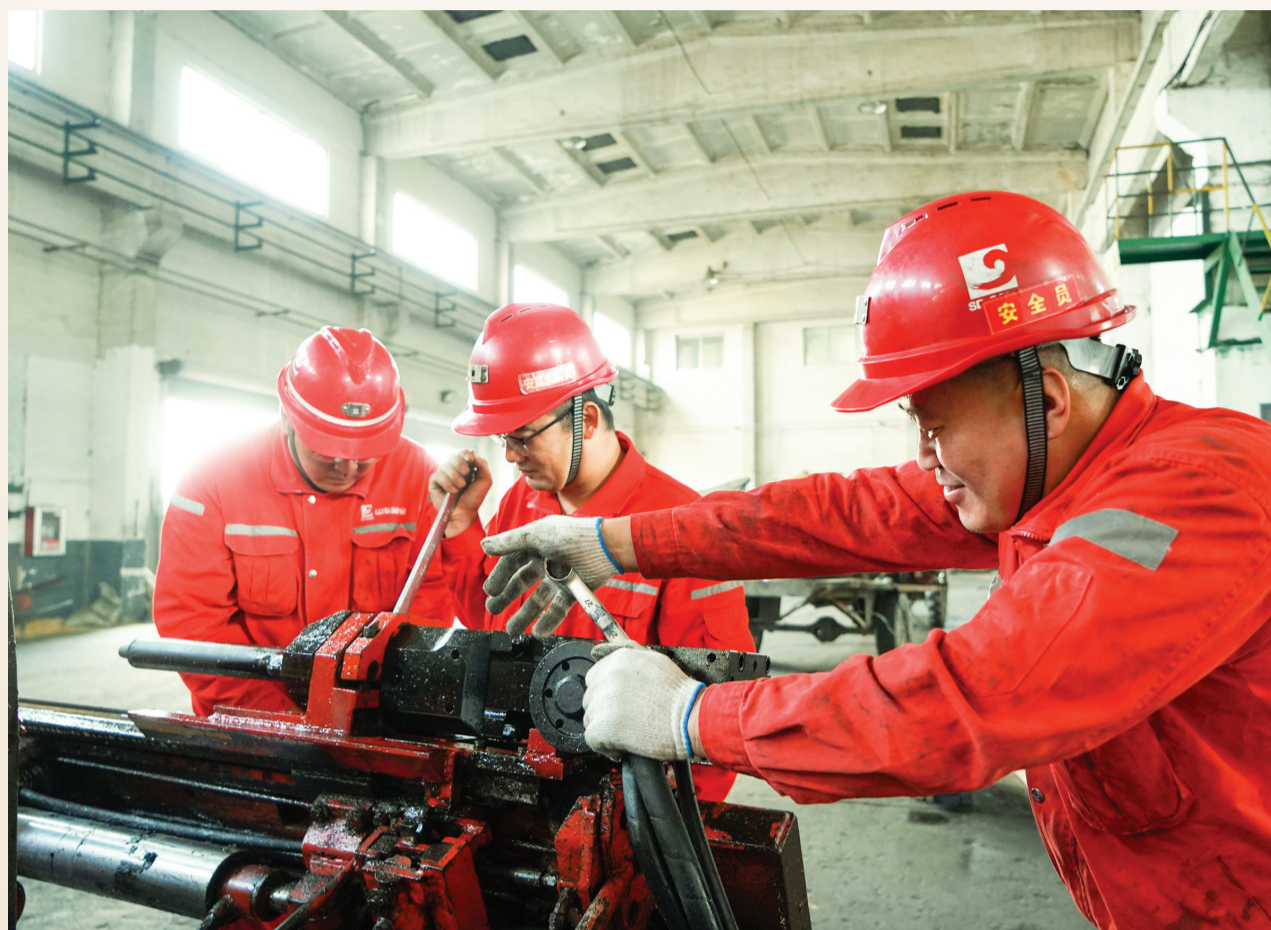
新城金矿技术人员定期对井下锚杆台车进行检修，确保安全生产
