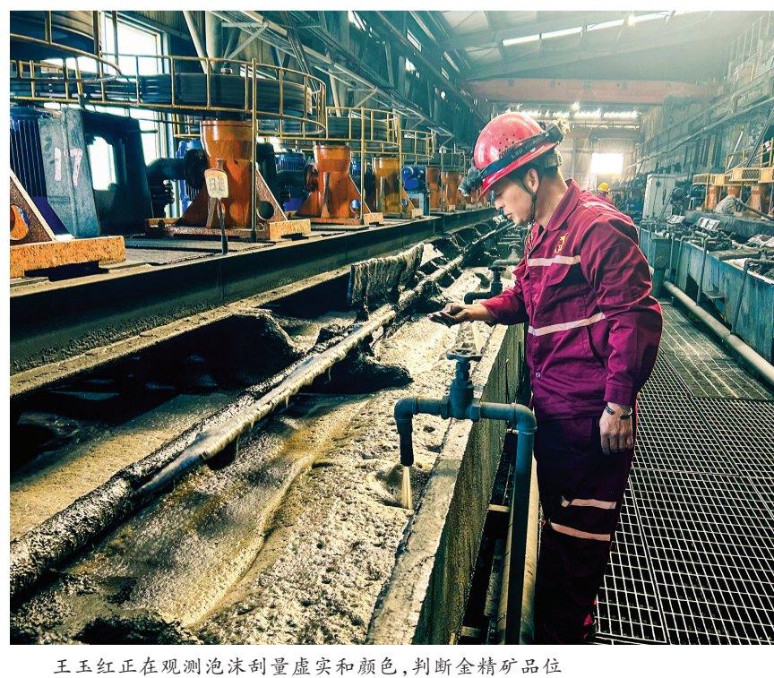
王玉红正在观测泡沫刮量虚实和颜色，判断金精矿品位
